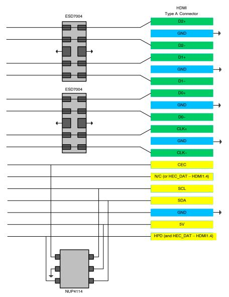
Figure 18. HDMI Layout Diagram
